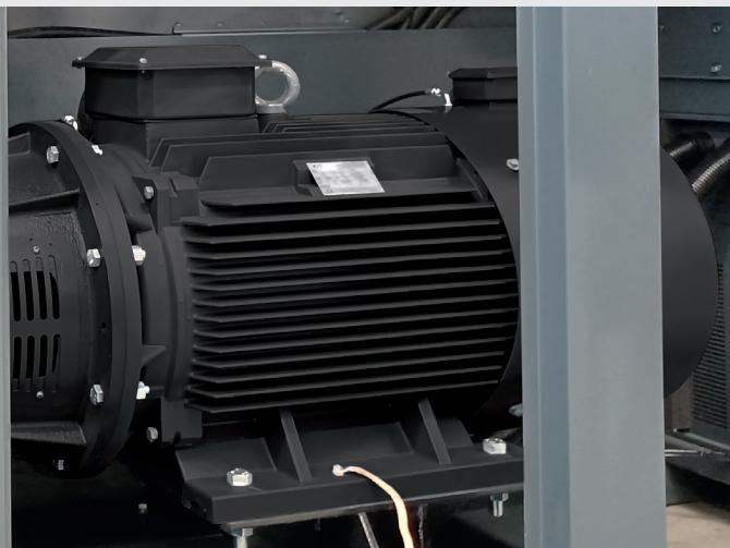
La scelta di un motore a bassa velocità di rotazione (4/6 poli nella versione a velocità fissa) e gruppi vite di dimensioni adeguate (max 1500 giri / min) garantisce una lunga durata nel tempo dei cuscinetti ed affidabilità dell'unità di compressione Bistadio.
